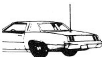
NELL'EVENTUALE USO DI SUPPORTI DI QUALSIASI TIPO, È MOLTO IMPORTANTE ACCERTARE CHE ESISTA UN OTTIMO COLLEGAMENTO ALLA MASSA DEL VEICOLO, DETTA VERIFICA, NON DEVE ESSERE FATTA CON L'APPARATO COLLEGATO, MA CONTROLLANDO, CON IL CONNETTORE STACCATO DAL RTX, CHE IL COLLEGAMENTO TRA SUPPORTO E CARROZERIA SIA REALE ED EFFICACE.
