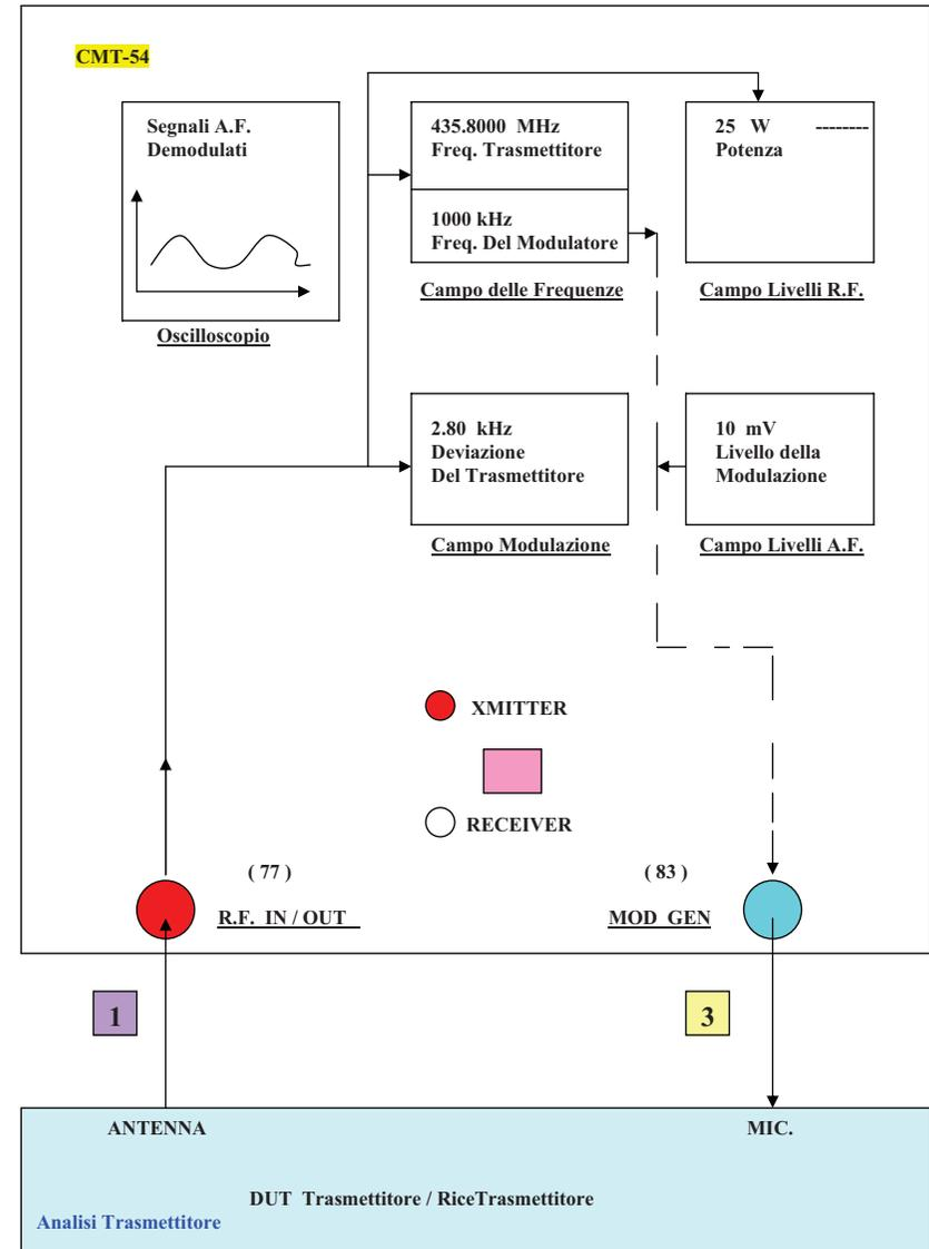
Nota : Assolutamente necessari per la misura della sensibilità della modulazione e della distorsione ( Frequenza di Test 1 kHz )
