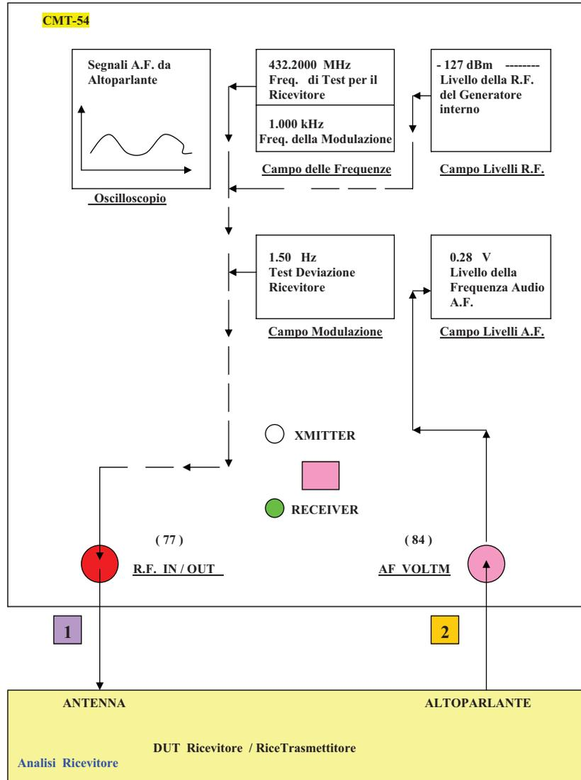
Nota : Assolutamente necessari per la misura della sensibilità e della distorsione del ricevitore
