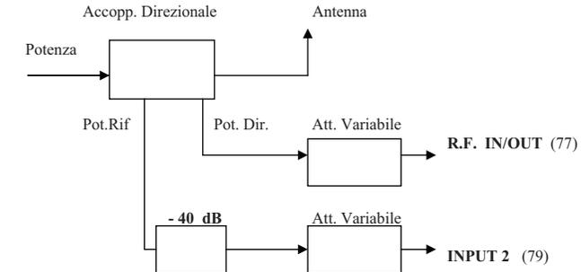
L'inserzione di un attenuatore addizionale di 40 dB compensa la differenza di sensibilità tra i due ingressi
