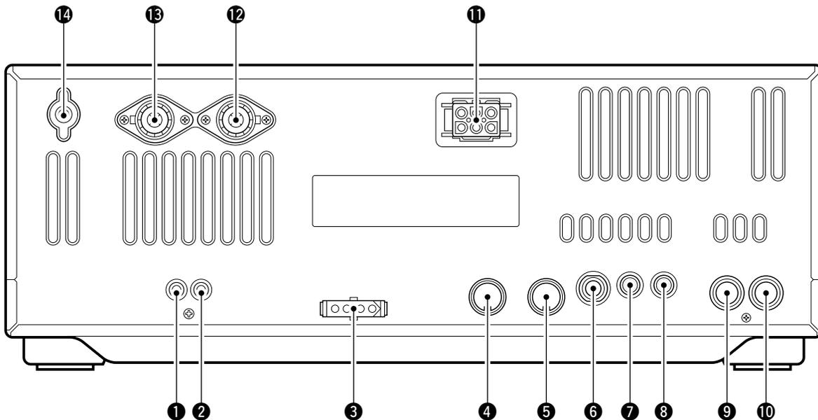
**1 RECEIVE ANTENNA CONNECTOR [RX ANT]**
