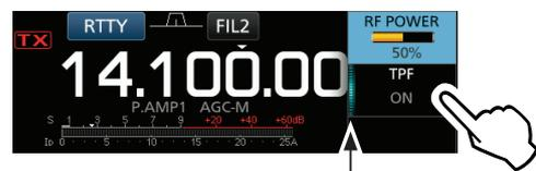
Die linke Kante der Schaltfläche leuchtet, wenn das Doppel-Peak-Filter eingeschaltet ist.
