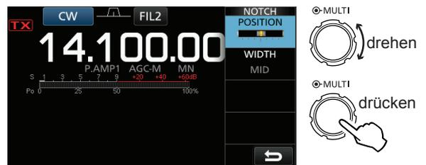
**HINWEIS:** Beim Abstimmen des manuellen Notch-Filters kann Rauschen hörbar werden. Dies entsteht im DSP und stellt keine Fehlfunktion des Transceivers dar.
