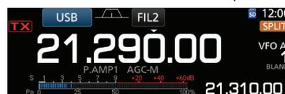
5. Der Transceiver empfängt auf 21,29000 MHz und sendet auf 21,31000 MHz.
