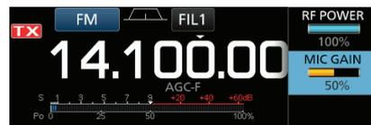
4. **(TRANSMIT)**-Taste drücken oder die **[PTT]** am Mikrofon gedrückt halten.
