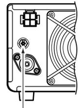
Für beste Erdungsergebnisse müssen Sie einen Erdungsdraht oder ein -band mit großem Querschnitt an einem Kupfer-Erdungsstab anschließen. Das Erdungskabel sollte möglichst kurz sein.
