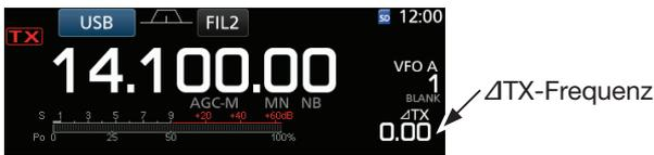
2. Die ΔTX-Frequenz so einstellen, dass die Sendefrequenz auf der Empfangsfrequenz der Gegenstation liegt.
