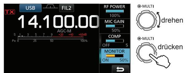
**HINWEIS:** Bei Benutzung der VOX-Voice-Delay-Funktion (S. 4-10) muss die Monitorfunktion ausgeschaltet werden, da das NF-Sendesignal andernfalls mit einem Echo überlagert würde.
