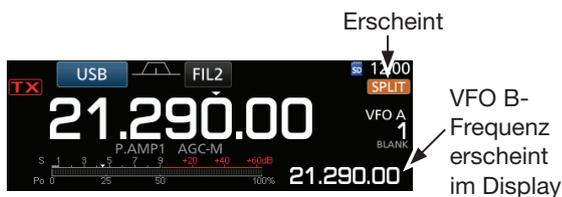
3. Bei gedrückt gehaltener **XFC**-Taste die Ablage zwischen Sende- und Empfangsfrequenz einstellen, die rechts im Display angezeigt wird.
