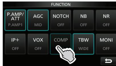
11. Beim Sprechen in das Mikrofon den in der Multifunktionsanzeige dargestellten Kompressionsgrad mit dem **MULTI**-Knopf so einstellen, dass der Zeiger des COMP-Meters bei normaler Sprechlautstärke im Bereich zwischen 10 und 20 dB (COMP-Zone) bleibt.
