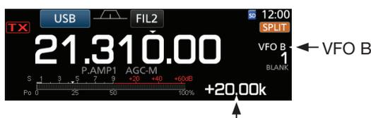
Ablage zwischen Sende- und Empfangsfrequenz bei gedrückt gehaltener **XFC**-Taste.
