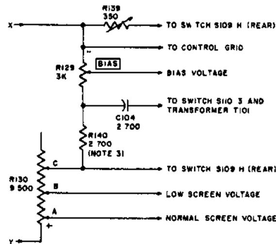
D VOLTAGE DIVIDER FOR BIAS VOLTAGE AND SCREEN VOLTAGE TV-70/U
